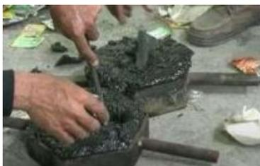
Gambar 7. Pencetakan *paving block*
