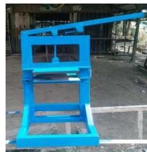
Gambar 11. Alat press *paving block* dengan mekanisme kunci
