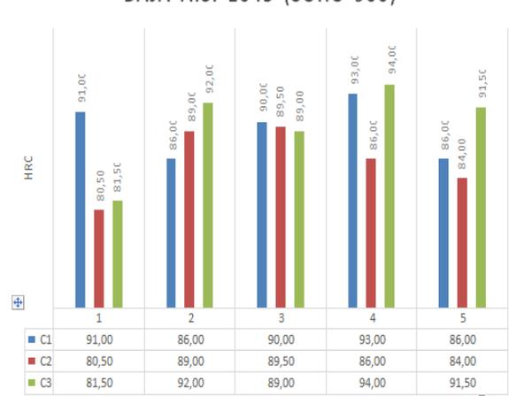
Gambar 5. Grafik Nilai Kekerasan Sampel dengan Temperatur 900°C
