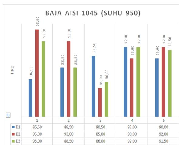
Gambar 6. Grafik Nilai Kekerasan Sampel Dengan Temperatur 950°C
