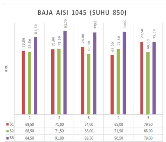
Gambar 4. Grafik Nilai Kekerasan Sampel dengan Temperatur 850°C
