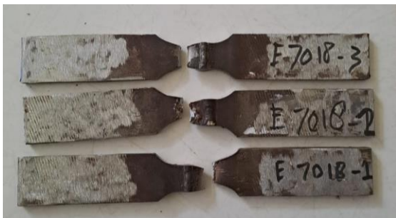
Gambar 13. Hasil uji tarik pengelasan menggunakan elektroda E 7018
