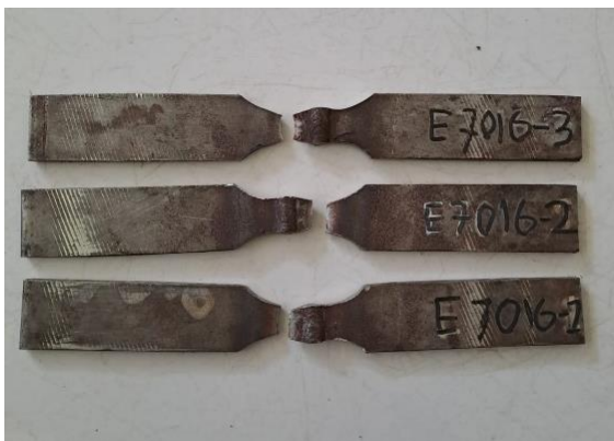
Gambar 12. Hasil uji tarik pengelasan menggunakan elektroda E 7016
