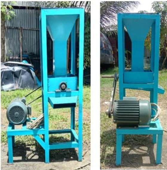
Gambar 3. Mesin penghancur arang tempurung kelapa
