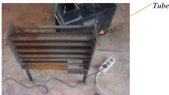
Gambar 6. Tahapan Pembuatan bagian tube HE
