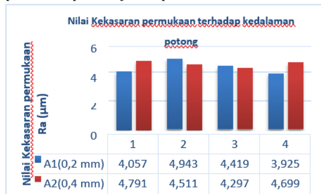
Gambar 2. Grafik Nilai Kekasaran permukaan terhadap kedalaman potong Baja ST 42 dengan putaran spindle 550 rpm.
