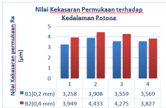
Gambar 3. Grafik Nilai Kekasaran permukaan terhadap kedalaman potong Baja ST 42 dengan putaran spindel 1020 rpm.
