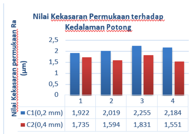
Gambar 4. Grafik Nilai Kekasaran permukaan terhadap kedalaman potong Baja ST 42 dengan putaran spindel 1800 rpm.
